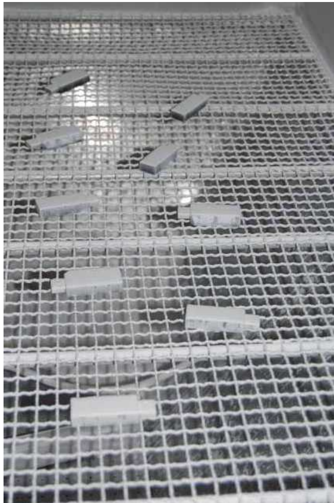
Bild 1: Prüflinge nach dem Staubtest
